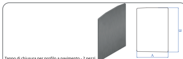
Tappo di chiusura per profilo a pavimento - 2 pezzi End cap for floor anchorage - 2 pieces
